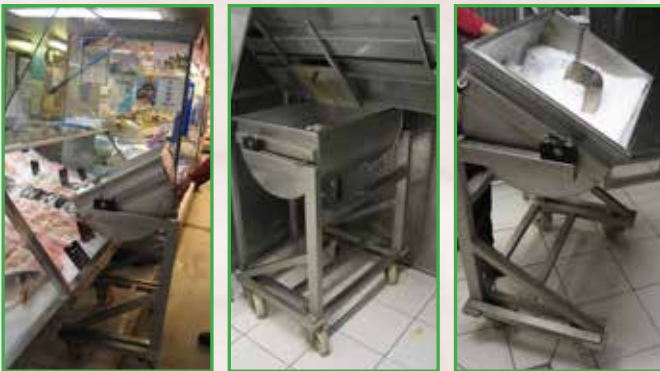
L'emploi d'un chariot basculant associé à une trémie facilite le transfert de la glace et sa mise en place sur les étales
