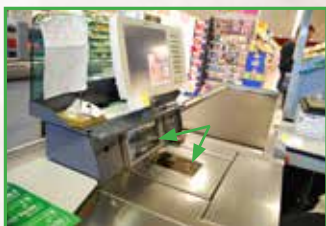
L'utilisation de poste d'encaissement à double scanner réduit le nombre de rotations des poignets lors de la lecture des codes-barres
