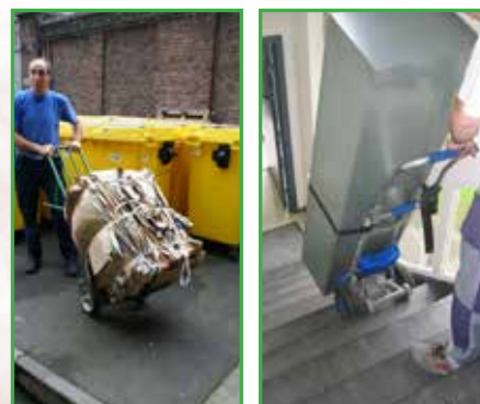
Diablos avec roues adaptées aux escaliers
