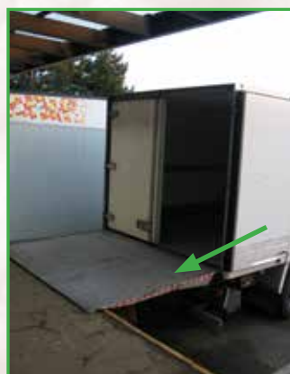
Dans les réceptions marchandises, l'utilisation privilégiée de niveleurs de quai hydraulique, de rampe et de hayons facilite l'accès au plancher du camion à partir du quai de chargement
