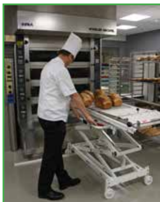
Un chariot d'enfournement semi-automatique à hauteur variable réduit les postures pénibles
