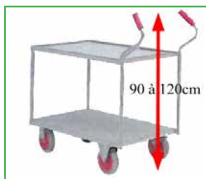
Chariots avec poignées situées à bonne hauteur (entre 90 et 120 cm)
