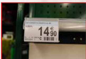
La mise en place d'un système de mise à jour des prix via étiquettes électroniques (EEG) réduit considérablement le nombre de manipulations liées à l'emploi des étiquettes papier
