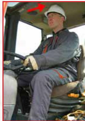
Distance insuffisante entre la tête du travailleur et le plafond de la cabine
